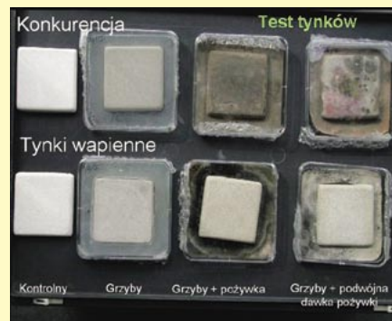
Zdjęcie 5. Test odporności tynków na korozję biologiczną.
